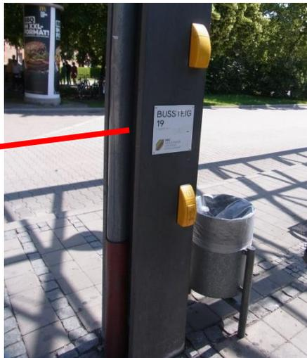
Allerdings gibt es keinerlei Leitsystem, um diese Taster aufzufinden. Man kann diese nur zufällig entdecken. Andere Gemeinde lösen dieses Problem dadurch, indem sie Taster verwenden, die Tickgeräusche von sich geben und so als „akustischer Leuchtturm“ dienen und aufgefunden werden können.
