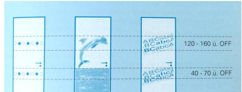
Beispiele für Sicherheitsmarkierungen an Glastüren, z. B. links: helle und dunkle Kreise oder Quadrate in Augen- und Kniehöhe. Mitte und rechts: Bildmotiv als Sicherheitsmarkierung: Die Normenvorgabe ist erfüllt, wenn in Augen- und in Kniehöhe in ausreichender Breite Wechselkontraste entstehen.
