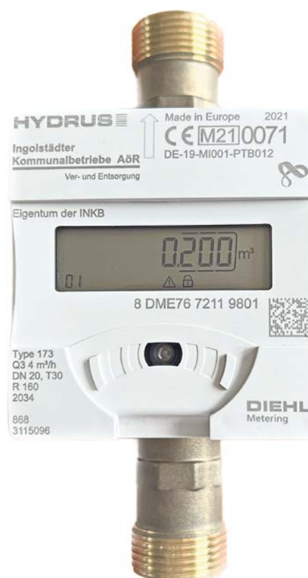
Ein neuer elektronischer Wasserzähler mit Funkmodul.
