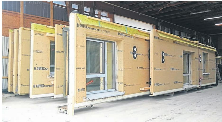
Die Fassadenelemente werden zeitsparend in einer Fertigungshalle vormontiert.
