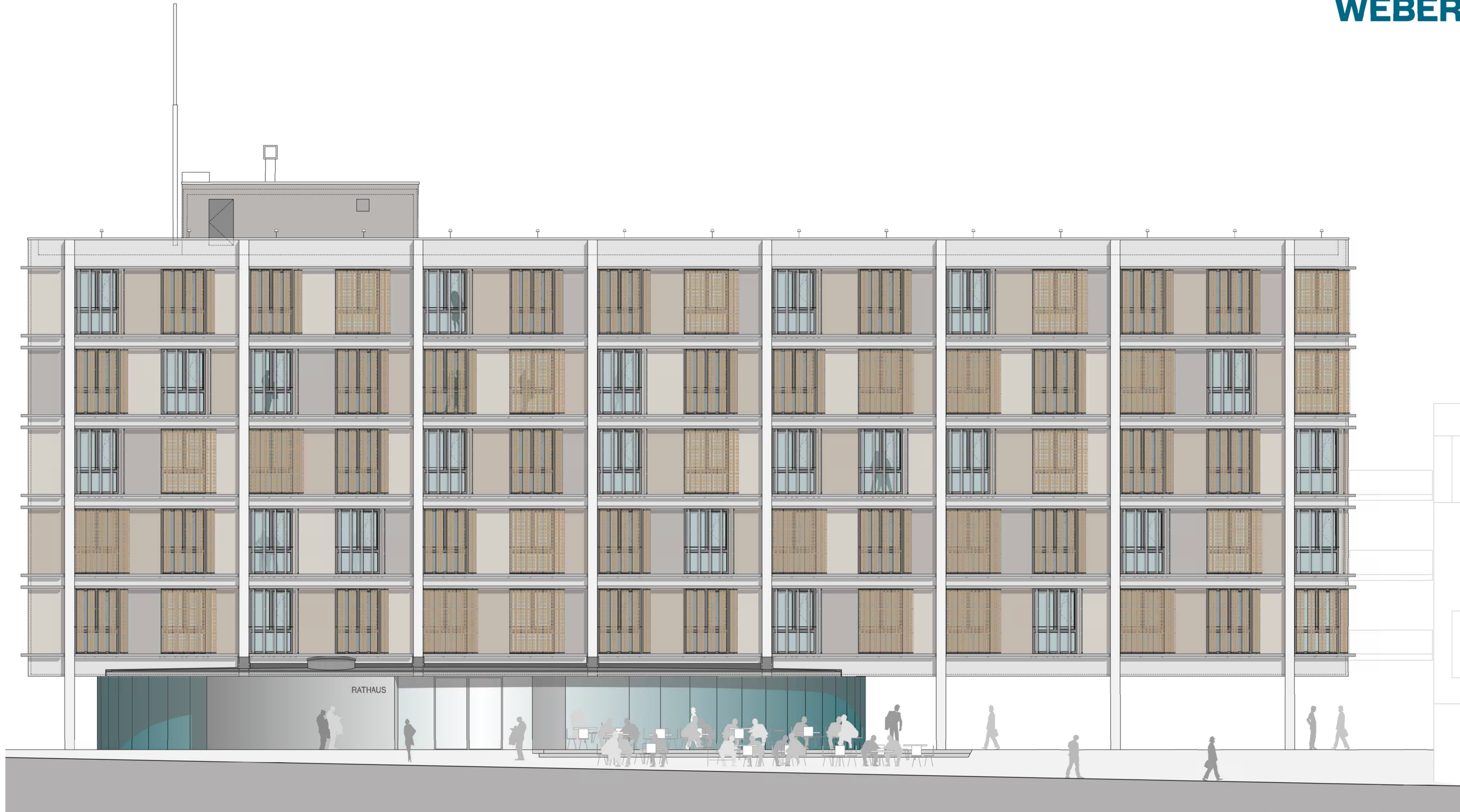
Fassade Neues Rathaus: Sonnenschutzlamellen mit integrierten Fotovoltaik-Zellen Westansicht, 1:75
