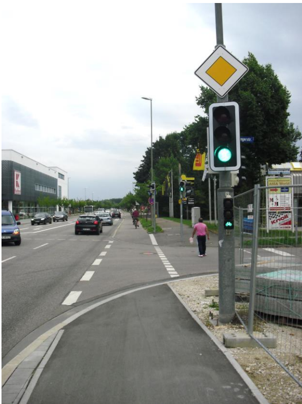
Abbildung 24 Eigener Signalgeber für Radfahrer (Bsp. Ingolstadt)
