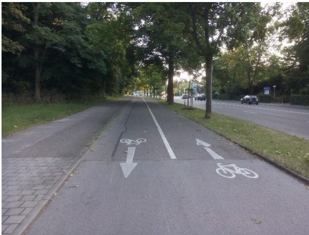
Abbildung 11 Einseitiger Zweirichtungsradsweg mit Mitteltrennstreifen (Bsp. Ingolstadt)
