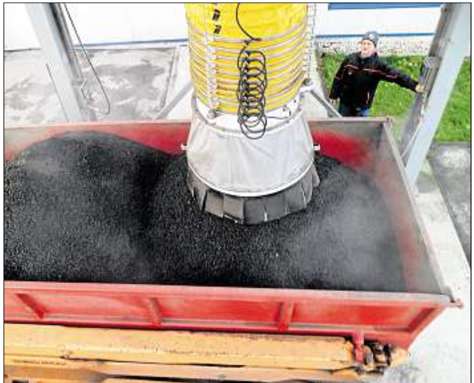
Brennwert wie Braunkohle: Der Klärschlamm wird in der ZKA mit Wärmeenergie aus der MVA zu Pellets getrocknet, die wiederum in der MVA zur Energiegewinnung genutzt werden.
