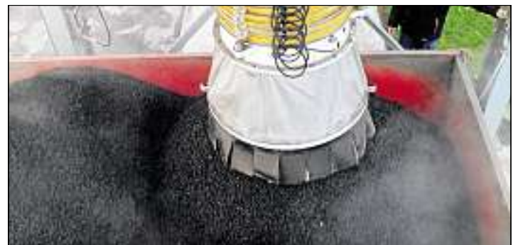
2. Die MVA verwertet getrockneten Klärschlamm der ZKA zur energetischen Verwertung.
