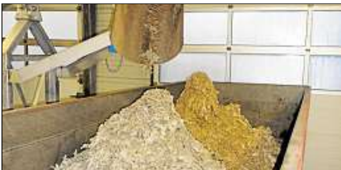
1. Die ZKA liefert Rechengut – die Grobstoffe aus dem Abwasser (zum Beispiel Klopapier) – zur MVA.
