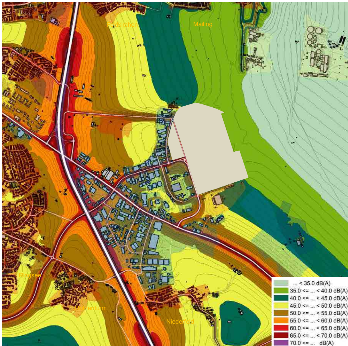
Abbildung 21: Prognose Planfall für das Jahr 2025 – Pegelverteilung im Untersuchungsgebiet bzgl. der Straßenverkehrsbelastung zur Nachtzeit (Rasterhöhe 5,6 m über Boden)
