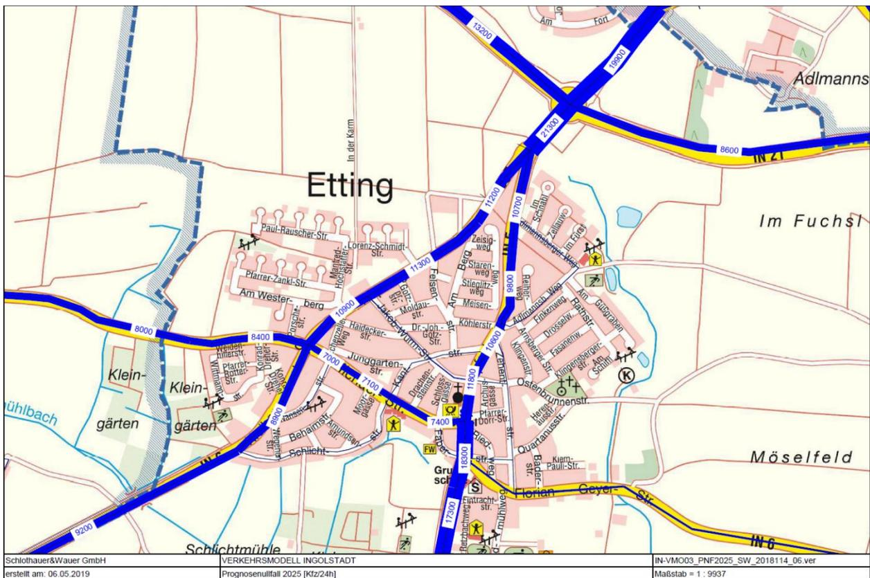
Abbildung 7: Verkehrsbelastungen Prognosenullfall 2025 [Kfz/24h]
