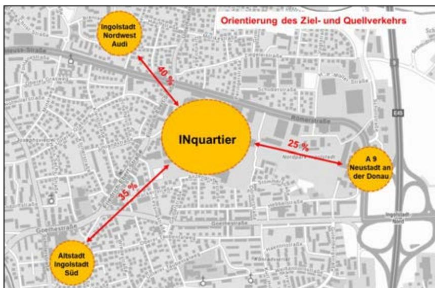
Bild 28: Aus den Erhebungen und Routenplanern abgeleiteter Ansatz zur Umlegung des Ziel- und Quellverkehrs für das Plangebiet
